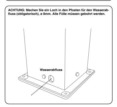
Lagerung vor der Installation: Lagern Sie das Produkt senkrecht in einem trockenen, belüfteten und vor Witterungseinflüssen geschützten Raum. Um in den Genuss der Garantie zu kommen, muss das Produkt nach den Regeln der Technik (DTU) installiert werden. Keine Scheuermittel auf die Pulverbeschichtung auftragen, mit Seifenwasser reinigen.
